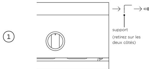
Retirez les supports sur les côtés de l'appareil et remplacez-les par les supports de fixation pour chariot fournis.
