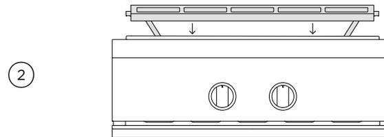
Réinstallez l'assemblage d'évent en réinsérant délicatement les tubes éclairs dans les supports, puis en abaissant l'assemblage.
