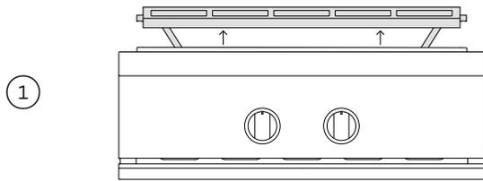
Retirez l'assemblage d'évent en le soulevant délicatement du produit, puis mettez-le de côté sur une surface protégée.
