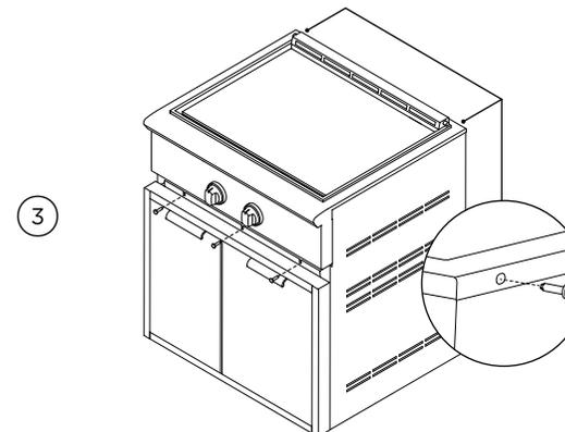
Fixez la plaque chauffante au chariot à l'aide de deux vis à tête étoilée à l'arrière et de trois vis à l'avant.
