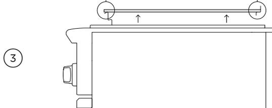
Soulevez l'assemblage de plaque chauffante et mettez-le de côté sur une surface protégée.
