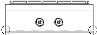
Utilisez un tournevis à tête étoilée pour retirer les 2 vis servant à fixer le panneau des valves sur l'appareil.
