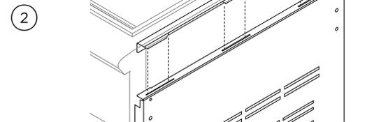
Placez la plaque chauffante sur le chariot en alignant les languettes arrière de l'appareil avec les fentes du chariot. Abaissez la plaque chauffante en alignant les languettes restantes.
