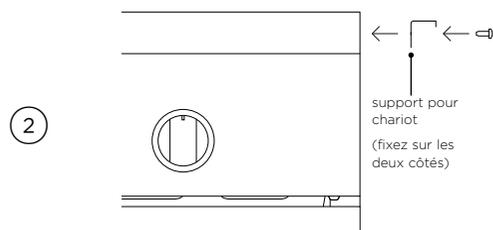
Fixez les supports de fixation pour chariot sur chaque côté à l'aide de quatre des vis 10-24 x 1/2" fournies.
